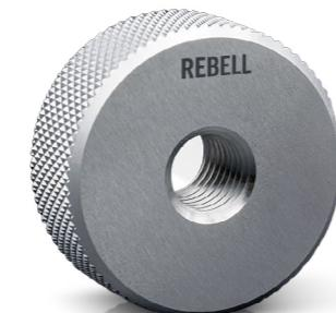
Ein Gewinde-Gutlehrring prüft das Paarungsmaß des Außengewindes. Er kontrolliert die Einhaltung des Flankendurchmessers, einschließlich der Formabweichung und Steigungsabweichung sowie Teilflankenabweichungen, die eine scheinbare Vergrößerung des Werkstückgewindes verursachen können. Außerdem wird die Einhaltung des Größtmaßes des Kerndurchmessers geprüft. Der Außendurchmesser des Außen gewindes wird nicht überprüft.
