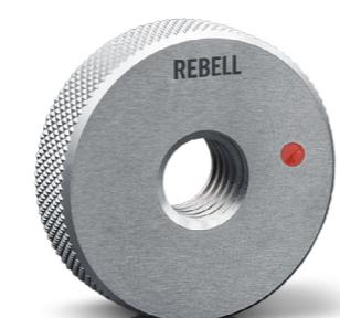
Ein Gewinde-Ausschusslehrring überprüft, ob der Ist-Flankendurchmesser des Werkstückes das festgelegte Mindestmaß unterschreitet, also ob der Flankendurchmesser zu klein ist. Dieser Lehrring darf sich von Hand, ohne Anwendung besonderer Kraft, nicht mehr als zwei Umdrehungen auf das Werkstückgewinde aufschrauben lassen. Sind mehr als zwei Umdrehungen möglich, entspricht das Werkstückgewinde nicht den Anforderungen.
